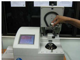
การนำตัวอย่างสารใส่ในเครื่องบอมบ์
