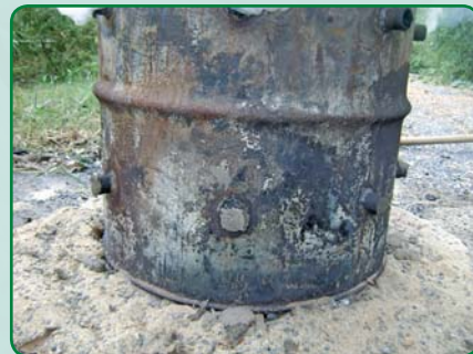
12. ปิดปล่องควันแถวล่างเมื่อเห็นไฟ ลุกแดง
