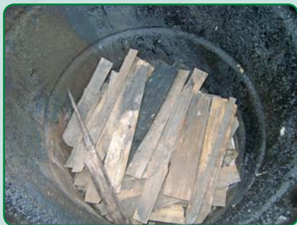
5. เชื้อไฟ ใช้เศษไม้ ปลายไม้ หรือใบไม้วางบริเวณก้นเตา
