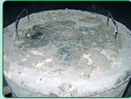
14. ปิดปล่องแถวบนและปล่องด้านบน เมื่อถ่านสุก “ซึ่งสังเกตได้จากควัน แสบจมูกเสบตาเปลี่ยนเป็นควันใส” รอนจนกระทั่งเตาเย็นลงจึงเก็บถ่าน
