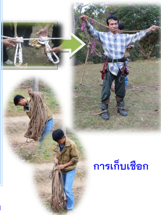
การทำปมปรัสซิค โดยใช้เชือกวงกลมพันรอบเชือกนิรภัย 2 ครั้ง
