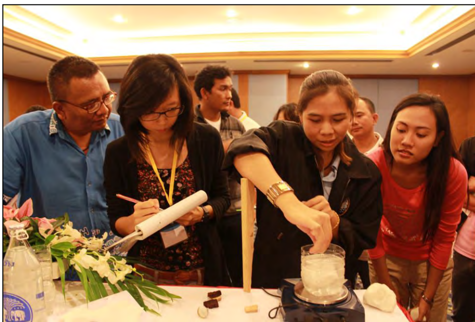
ภาพที่ 28 แสดงวิธีการหา Basic Wood Density เพื่อใช้ในการคำนวณหามวลชีวภาพของต้นไม้ตาย
