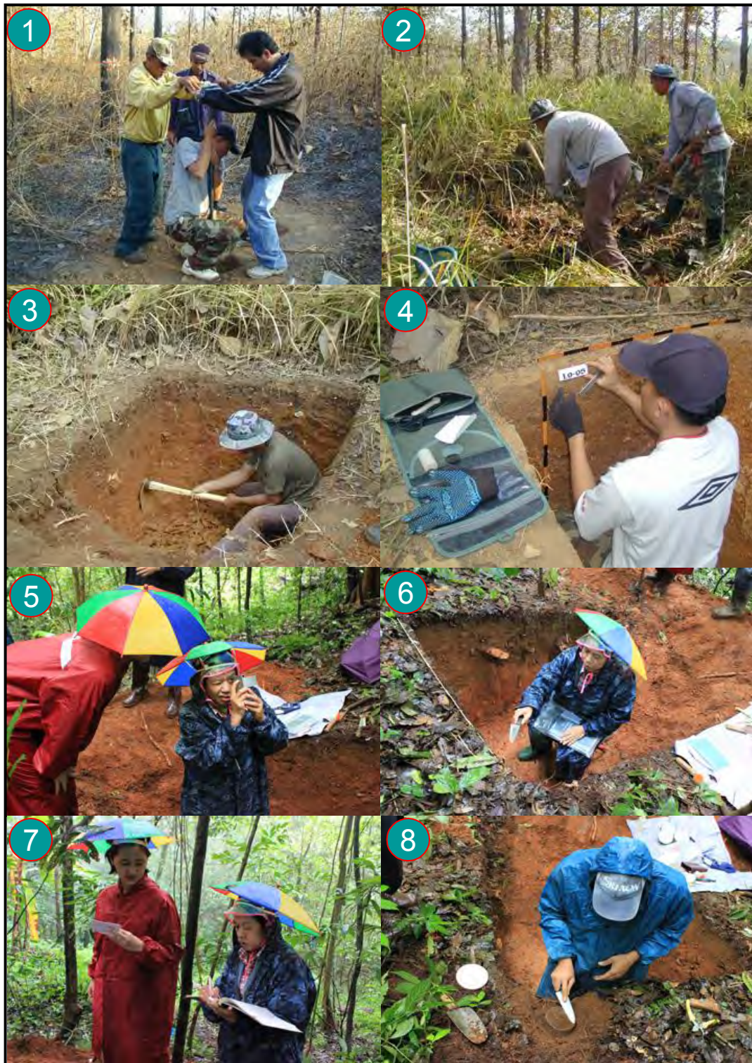
ภาพที่ 30 เทคนิคการเก็บข้อมูลคาร์บอนในดิน 1) วิธีเก็บตัวอย่างดินตามระดับความลึกโดยใช้ส่วนเจาะดิน 2) การเตรียมพื้นที่สำหรับการทำชั้นหน้าตัดดิน 3) ขุดดินออกให้มีความกว้าง ยาว ลึก 1 ลูกบาศก์เมตร 4) จัดเตรียมชั้นหน้าตัดดินให้เรียบร้อย 5) วัดสภาพความลาดชันของพื้นที่บริเวณหลุมเก็บตัวอย่าง 6) ทำการบรรยายรายละเอียดของชั้นหน้าตัดดินแต่ละชั้น 7) จดบันทึกข้อมูลทั้งหมด 8) เก็บตัวอย่างดินส่งห้องปฏิบัติการ
