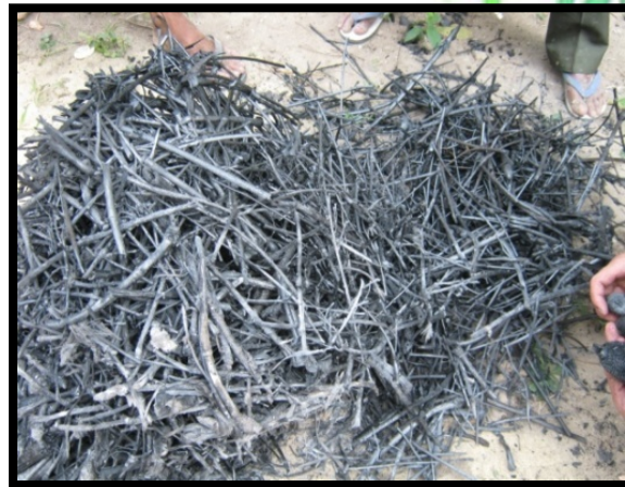
เผาให้เป็นถ่านเพื่อนำไปอัดเป็นแท่ง
