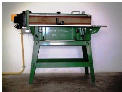
เครื่องขัดสายพานเพลตตั้ง Vertical Belt Sander
