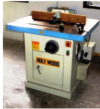
เครื่องลอกบัวแบบเพลาตั้งหัวทราย Shaper
