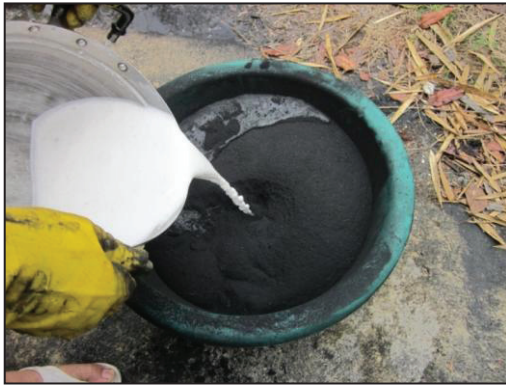
ภาพที่ 7 การผสมถ่านบดกับกาวแป้งมันสำปะหลัง เพื่อนำไปอัดแท่ง
