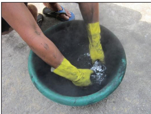
ภาพที่ 5 การผสมถ่านบดกับแป้งมันสำปะหลัง เพื่อนำไปอัดแท่ง
