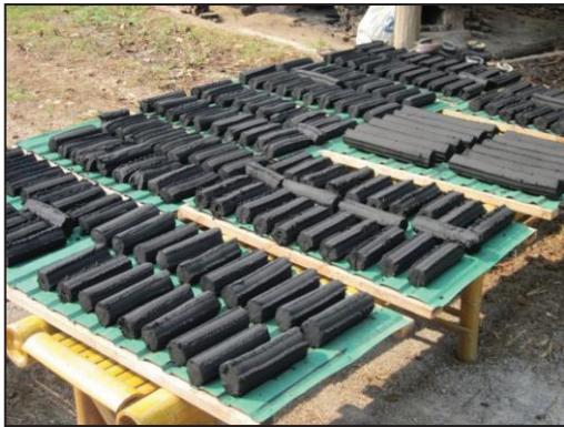
ภาพที่ 3 การฟ้งถ่านอัดแท่งจากส่วนผสมต่าง ๆ เพื่อเตรียมนำไปทดสอบ และหาประสิทธิภาพการใช้งาน
