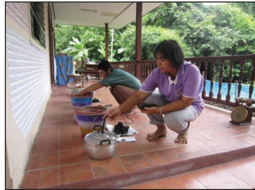
ภาพที่ 4 การทดสอบประสิทธิภาพการใช้งาน โดยใช้เตาหุงต้มประสิทธิภาพสูงของกรมป่าไม้
