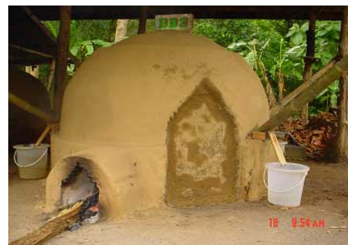
ภาพที่ 7. เตาอิฐกรมป่าไม้ พร้อมปล่องคักน้ำส้มคว้นไม้
