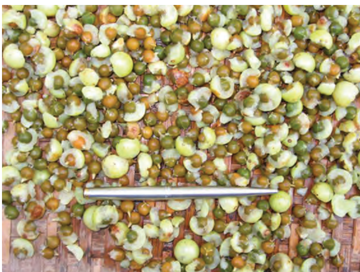
ภาพที่ 5 ผลมะขามป้อมที่ได้จากการบดด้วยเครื่องแยกเมล็ดกาแฟ ซึ่งมี Stone เพียงบางส่วนที่เนื้อหลุดออกหมดแล้ว แต่ส่วนมากยังมีเนื้อติดอยู่
