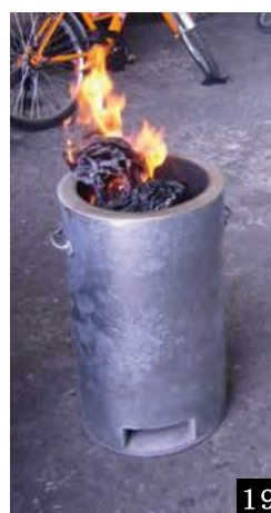
ภาพที่ 4 ตัวอย่างเตาเผากระดาษไหว้เจ้าทดลองที่ได้คัดเลือกว่ามีประสิทธิภาพดี
