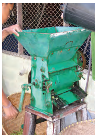
ภาพที่ 3 เครื่องแยกเมล็ดกาแฟ ซึ่งต้องใช้แรงงาน ในการหมุนเครื่อง
