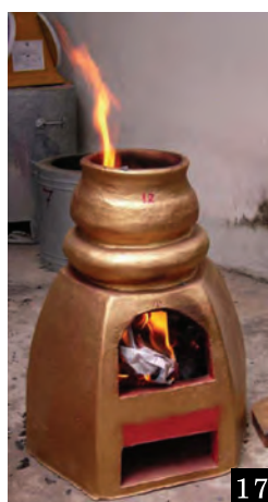
ภาพที่ 4 ตัวอย่างเตาเผากระดาษไหว้เจ้าทดลองที่ได้คัดเลือกว่ามีประสิทธิภาพดี
