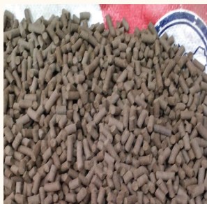
เชื้อเพลิงอัดเม็ดที่ไม่ผ่าน กระบวนการ Torrefaction
