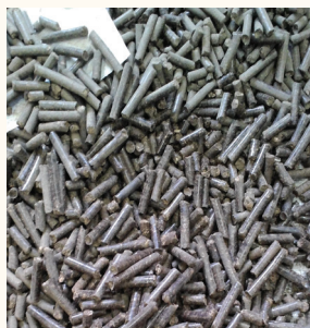
เชื้อเพลิงอัดเม็ดที่ผ่าน กระบวนการ Torrefaction
