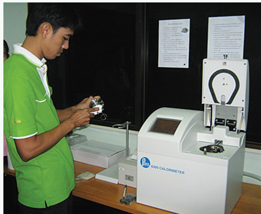
เครื่องบอมป์แคลอริมิเตอร์
