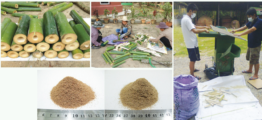
การเตรียมตัวอย่างชีวมวลที่จะสกัดน้ำมันชีวภาพ
