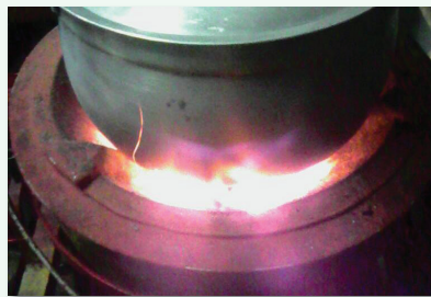
การทดสอบเตาอเนกประสงค์ โดยใช้ถ่านเป็นเชื้อเพลิง
