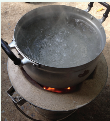
การทดสอบเตาอเนกประสงค์ โดยใช้ถ่านเป็นเชื้อเพลิง
