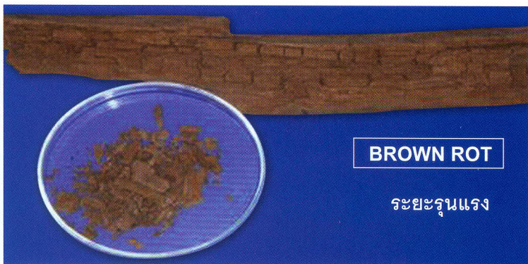
ภาพที่ 4. ลักษณะเนื้อไม้ภายหลังถูกทำลายเนื้อไม้แตกตามขวาง แนวเส้นขนานใหญ่
