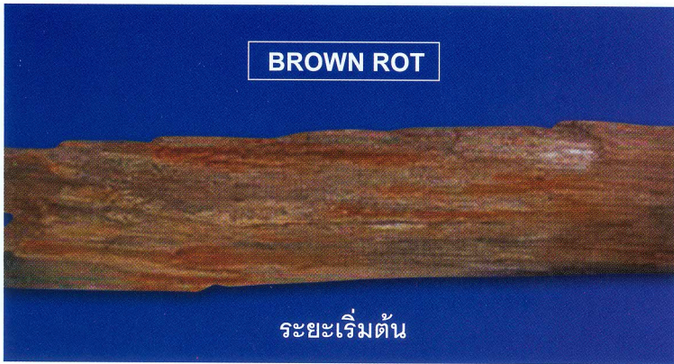
ภาพที่ 3. ลักษณะเนื้อไม้ภายหลังถูกเชื้อราสีน้ำตาลเข้าทำลายเนื้อไม้ จะมีสีน้ำตาลเข้มรอยแตกไม่ชัดเจน
