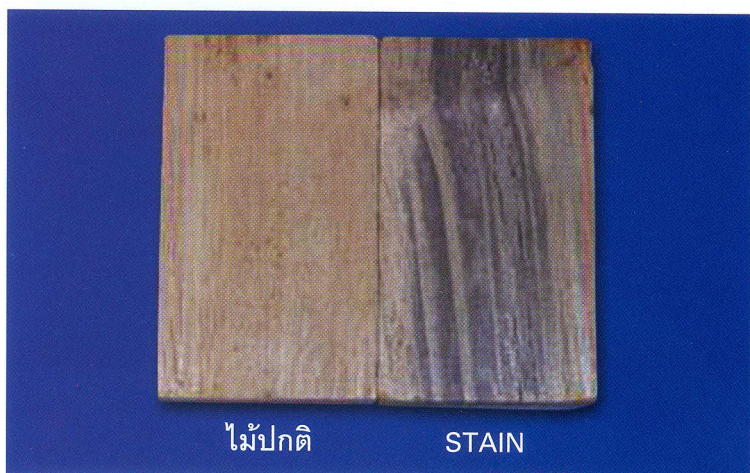
ภาพที่ 6. ลักษณะการเกิดราเสียสีในไม้เนื้อสีขาว เส้นใยเชื้อราจะเจริญตามรัศมีพาราเรโนไม
