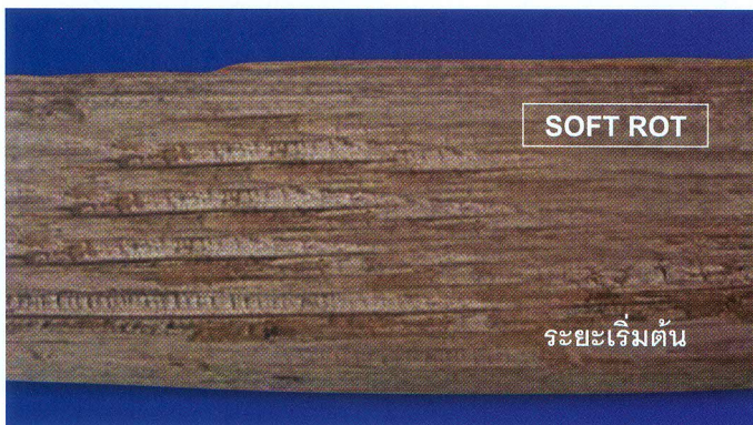
ภาพที่ 5. ลักษณะเนื้อไม้ที่ถูกเชื้อราผุอ่อนเข้าทำลายมีลักษณะคล้ายราฟูน้ำตาล แต่รอยแตกจะเล็กและตื้น
