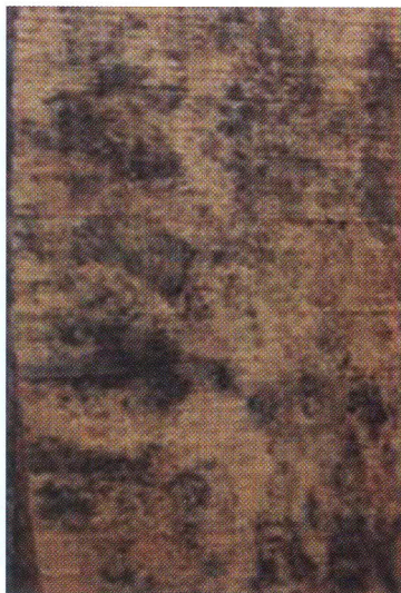
ภาพที่ 9. ลักษณะผิวเนื้อไม้เกิดการปนเปื้อนจากกลุ่มสปอร์ของเชื้อราผิวไม้
