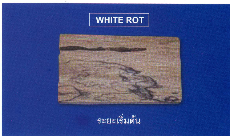
ภาพที่ 1. ลักษณะเนื้อไม้ที่มีรอยสีน้ำตาลหรือดำเป็นเส้นสาย เรียกว่า zone line
