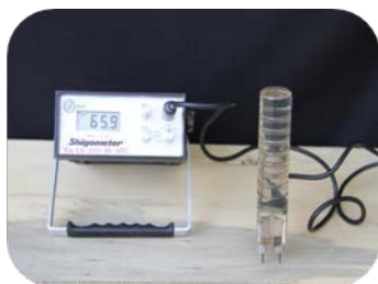
ภาพที่ 19 เครื่อง Shigometer สำหรับตรวจสอบการผุพังของไม้หลังตัดฟัน และไม้ยืนต้น
