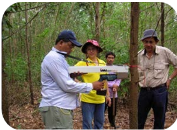
ภาพที่ 18 เครื่อง Resistograph สำหรับตรวจสอบการผุพัง
