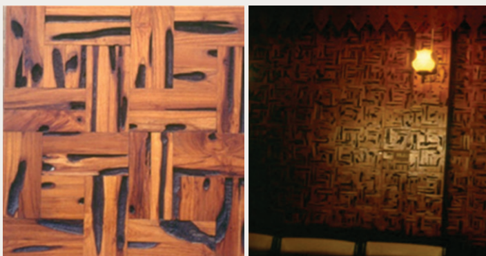
ภาพที่ 13 ลักษณะการใช้ประโยชน์ไม้ที่ถูกหนอนผิเสื่อเจาะ
