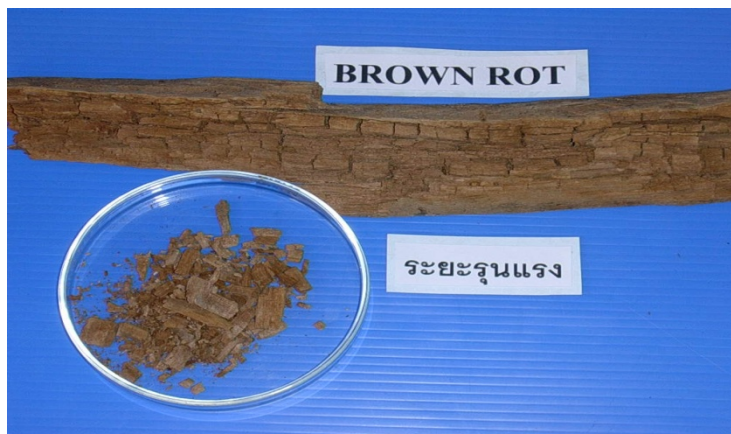
ภาพที่ 4. ลักษณะเนื้อไม้ภายหลังถูกทำลายเนื้อไม้แตกตามขวางแนวเส้นใยขนาดใหญ่
