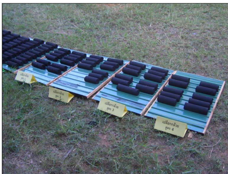
ภาพที่ 3 ถ่านอัดแท่งที่มีส่วนผสมระหว่างถ่านเปลือกกล้วยบด 2,000 กรัม กับกาวแป้งมันสำปะหลังที่ระดับความเข้มข้นต่างๆ กัน
