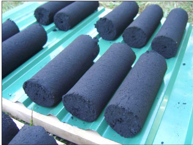
ภาพที่ 4 ถ่านอัดแท่งที่มีส่วนผสมระหว่างถ่านเปลือกกล้วยบด 2,000 กรัม กับกาวแป้งมันสำปะหลังที่ระดับความเข้มข้น 10 %
