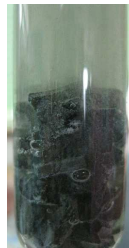
เกิดฟองอากาศผุดขึ้นมาจากถ่าน มากขึ้นเมื่อปริมาณถ่านเพิ่มมากขึ้น
