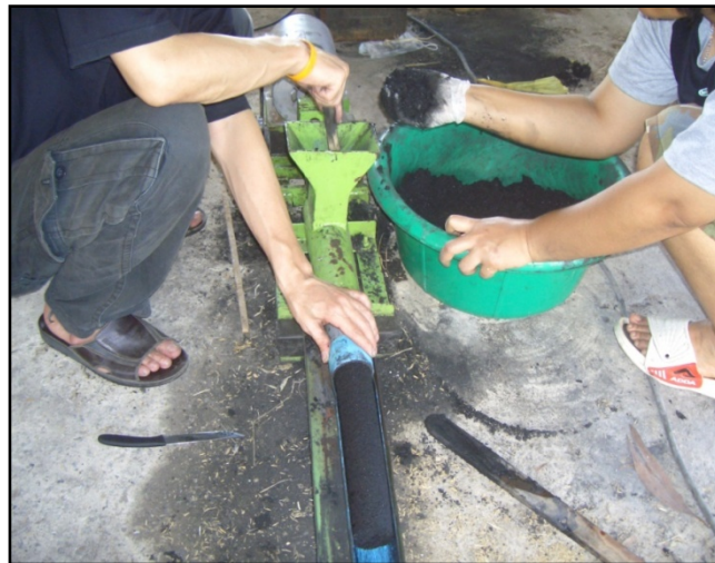
ภาพที่ 7. การอัดถ่านให้เป็นแท่งด้วยเครื่องอัดแท่งเชื้อเพลิงแข็งแบบอัดเย็น
