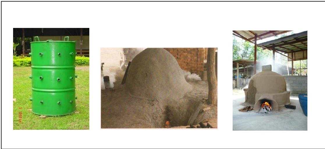
ภาพที่ 1 เตาถังเขียว เตาดินเหนียวก่อ และเตาอิฐก่อของกรมป่าไม้ที่ใช้ในการทดลอง
