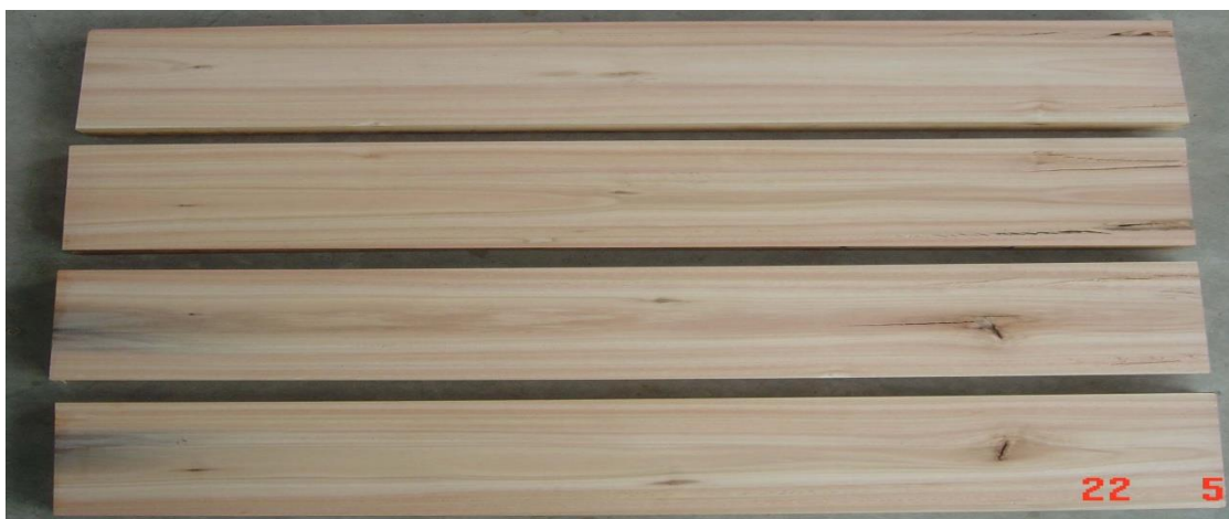
ภาพที่ 62 แสดงลักษณะของแผ่นไม้ยูคาลิปตัสท่อนที่ 16 หลังการแปรรูป
