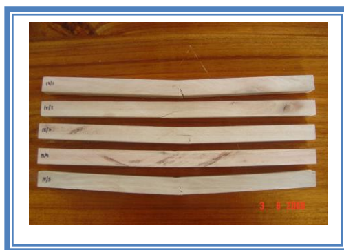
ภาพที่ 23 ชิ้นตัวอย่างหลังทดสอบ
