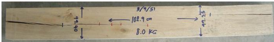
ภาพที่ 76 แสดงลักษณะไม้ยูคาลิปตัสท่อนที่ 23 หลังการแปรรูปเป็นระยะเวลา 207 วัน
