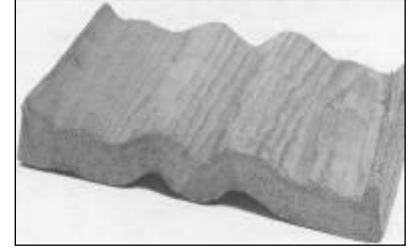
ตำหนิแบบขยุตัวของเนื้อไม้
