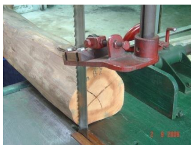
ภาพที่ 14 ทำการเปิดปีกไม้ด้วยเลื่อยสายพาน
