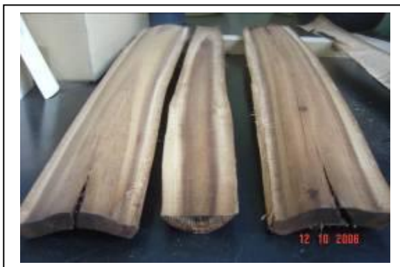
ตำหนิการเกิดขยุตัวและโก่งแตกปลาย ที่เกิดจากการปลดปล่อยความเค้นจากการเจริญเติบโต
