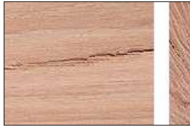
ตำหนิแบบแตกและบิดงอ
