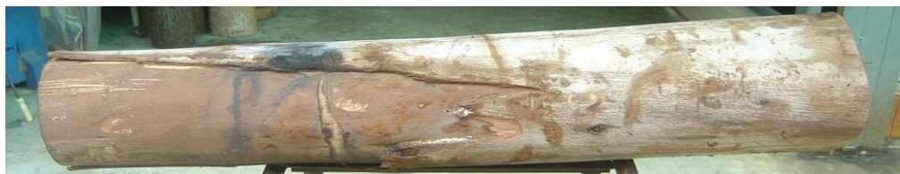
ภาพที่ 59 แสดงลักษณะของไม้ยูคาลิปตัสท่อนที่ 16 หลังการอบร้อน
