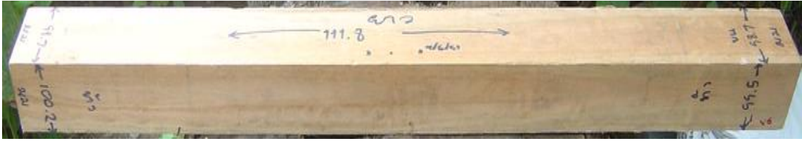
ภาพที่ 42 แสดงลักษณะของไม้ยูคาลิปตัสท่อนที่ 2 หลังการแปรรูปเป็นระยะเวลา 231 วัน
