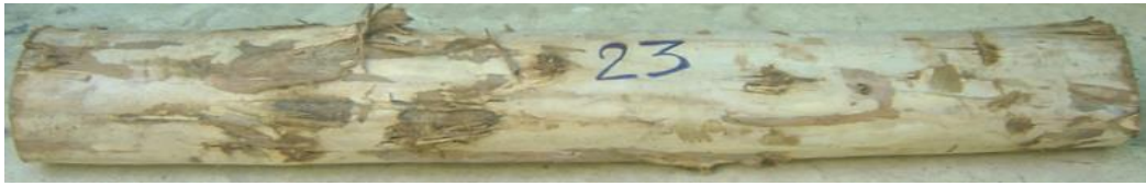
ภาพที่ 73 แสดงลักษณะไม้ยูคาลิปตัสท่อนที่ 23 ก่อนการอบร้อน
