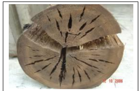
ตำหนิ การแตกแบบรังผึ้ง ที่เกิดจาก การปลดปล่อยความเค้นจากการเจริญเติบโต
