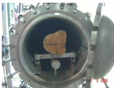
ภาพที่ 12 นำไม้เข้าเตาอบ
