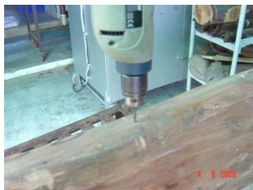
ภาพที่ 13 ทำการเจาะด้วยสว่านไฟฟ้าและวัดอุณหภูมิของท่อนไม้ด้วยเทอร์โมมิเตอร์
