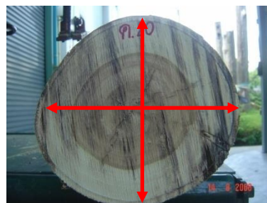
ภาพที่ 11 ทำการวัดขนาดความยาวและวัดขนาดเส้นผ่านศูนย์กลาง
