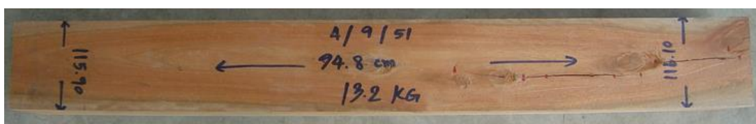
ภาพที่ 40 แสดงลักษณะของไม้ยูคาลิปตัสท่อนที่ 26 หลังการแปรรูปเป็นระยะเวลา 208 วัน
