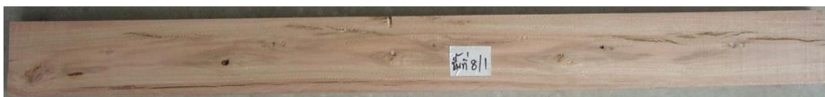
ภาพที่ 56 แสดงลักษณะของไม้ยูคาลิปตัสท่อนที่ 6 หลังการแปรรูปเป็นระยะเวลา 225 วัน
