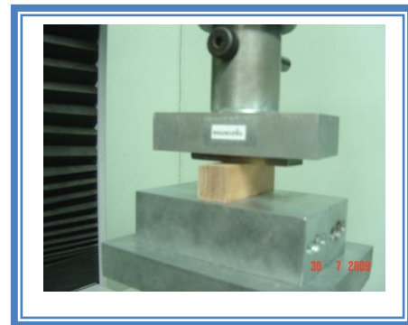
ภาพที่ 28 ชิ้นตัวอย่างขณะทดสอบ
