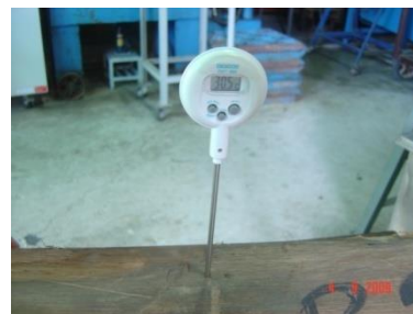
ภาพที่ 13 ทำการเจาะด้วยสว่านไฟฟ้าและวัดอุณหภูมิของท่อนไม้ด้วยเทอร์โมมิเตอร์
