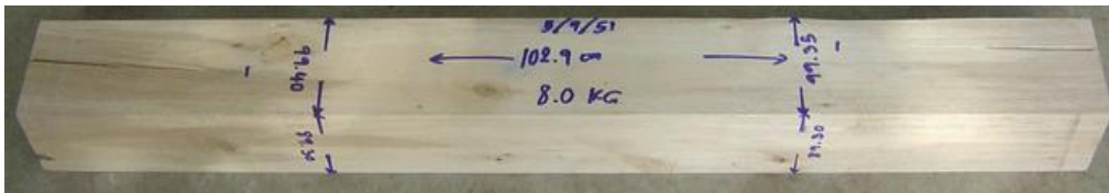
ภาพที่ 75 แสดงลักษณะไม้ยูคาลิปตัสท่อนที่ 23 ที่แปรรูปภายหลังการอบร้อน
