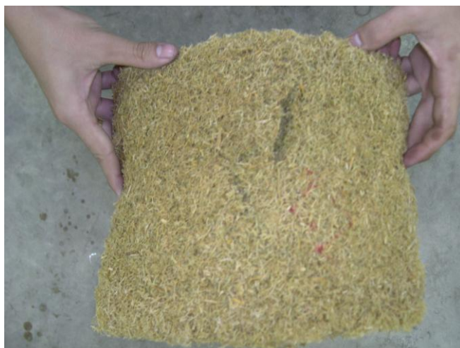
รูปที่ 13 การฉีกขาดของแผ่นฉนวน
