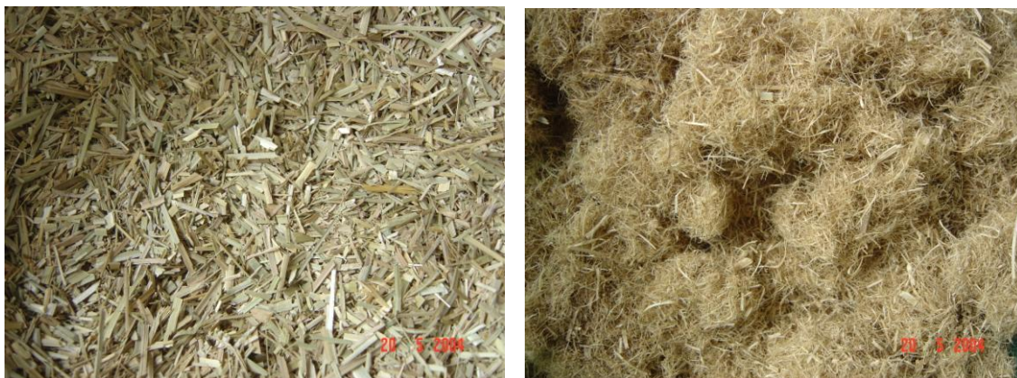
ภาพที่ 35 ลักษณะของจีนหญ้าแฝกไม่ผ่านการปรับปรุงผิว (ซ้าย) ลักษณะของจีนหญ้าแฝกที่ผ่านแรงดันไอน้ำสูง (ขวา)
