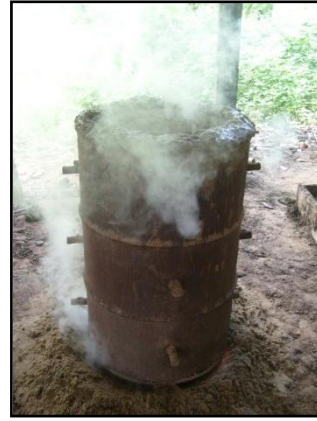
ภาพที่ 2 การทดลองเผาถ่านเปลือกกล้วยด้วยเตาถังเดียว
