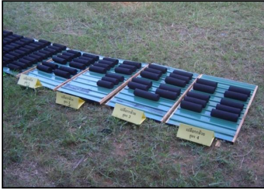
ภาพที่ 3 ถ่านอัดแท่งที่มีส่วนผสมระหว่าง ถ่านเปลือกกล้วยอบต 2,000 กรัม กับกาวแป้งมันสำปะหลังที่ระดับ ความเข้มข้นต่างๆ กัน
