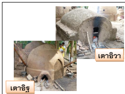
ภาพที่ 2 เตาอิฐก่อและเตาอิฐวะเตะ
