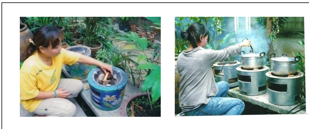
ภาพที่ 3 การทดสอบประสิทธิภาพการใช้งานของเชื้อเพลิงอัดแท่งด้วยวิธีการต้มน้ำ
