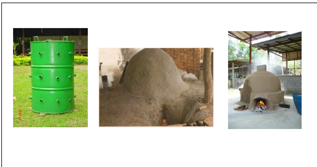
ภาพที่ 1 เตาถ่านเดี่ยว เตาดินเหนียวก่อ และเตาอิฐก่อของกรรมป่าไม้ที่ใช้ในการทดลอง
