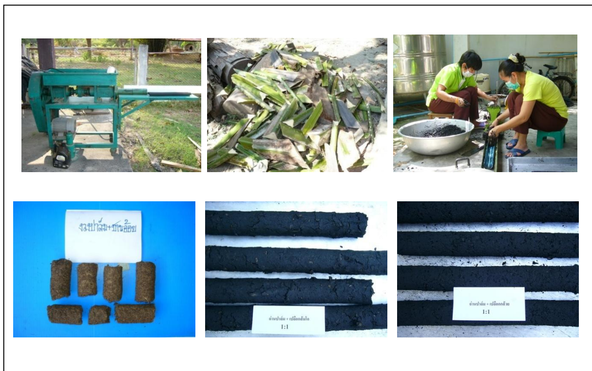
ภาพที่ 2 เครื่องอัดเชื้อเพลิงแบบอัดเย็น กาบปาล์ม และเชื้อเพลิงอัดแท่งจากปาล์ม
