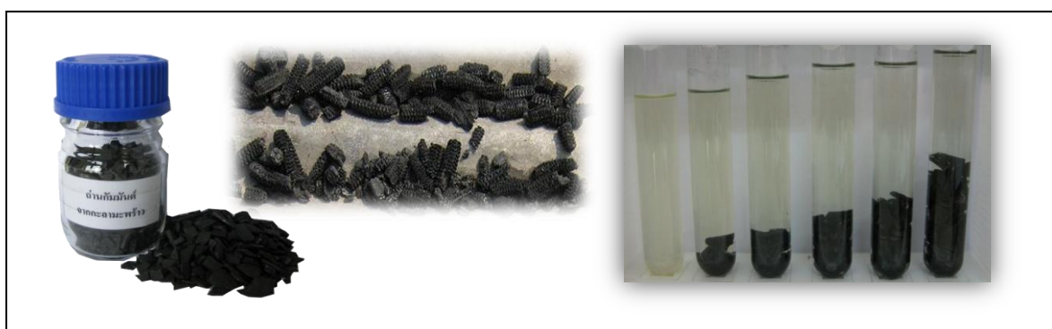
ภาพที่ 4 ถ่านกัมมันต์จากกะลามะพร้าว ถ่านกัมมันต์จากซังข้าวโพด และการทดสอบการดูดซับสี และกลิ่นของน้ำทิ้ง
