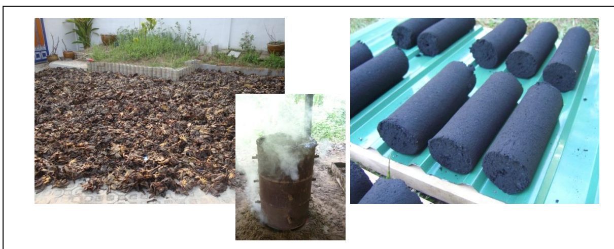
ภาพที่ 2 เปลือกกล้วยน้ำหว่า เตาถังเดี่ยวสำหรับเผาเปลือกกล้วย และถ่านอัดแท่งจากเปลือกกล้วย
