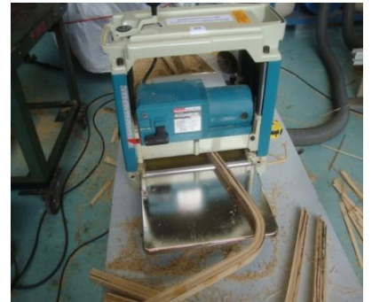
ไม้ไผ่ซีกอัดประสานที่ไสด้วยเครื่องไสขนาด
