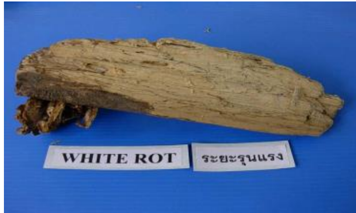
ภาพที่ 1 ลักษณะเนื้อไม้ภายหลังถูกเชื้อราสีขาวเข้าทำลายเนื้อไม้ จะเปื่อยยุ่ย มีลักษณะสีขาว ไม่มีรอยแตกตามขวางเส้น
