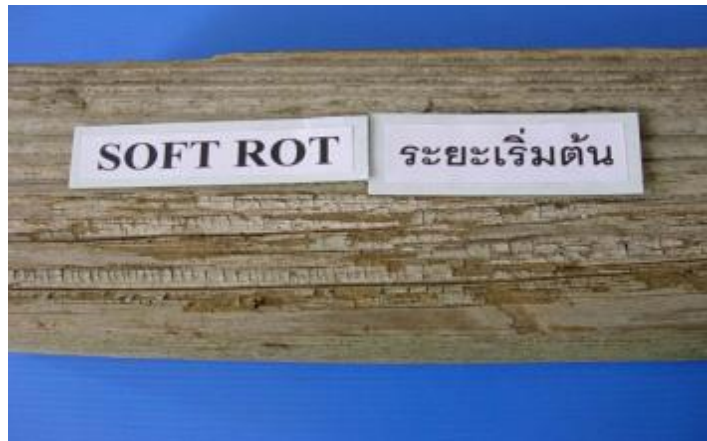
ภาพที่ 3 ลักษณะเนื้อไม้ที่ถูกเชื้อราผุอ่อนเข้าทำลาย
