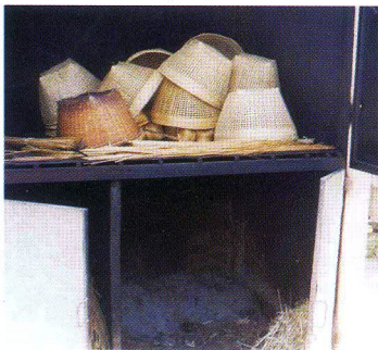
ภาพ เตาอบเครื่องจักสานไม้ไผ่ด้วยความร้อน
